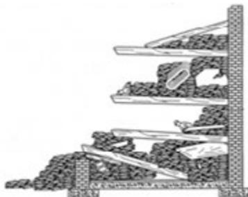
Colapso de tipo suspendido
